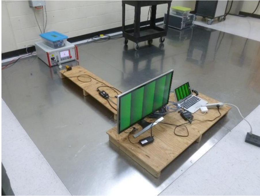
Photo 26: EFT – Test Setup
