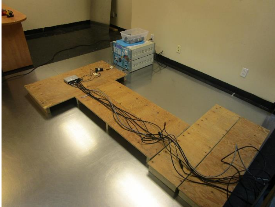
Photo 28: EFT – Test Setup
