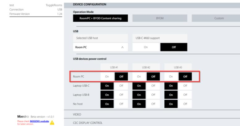
Maestro – Contrôleur d'appareils (logiciel pour TOGGLE ROOMS) Assurez-vous de couper l'alimentation USB lorsque vous sélectionnez le PC Room dans notre logiciel Maestro.
