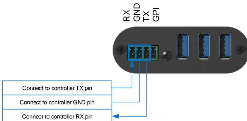
**Baud rate:** 9600 // **Data bits:** 8 // **Stop bits:** 1 // **Parity:** None // **Flow control:** None
